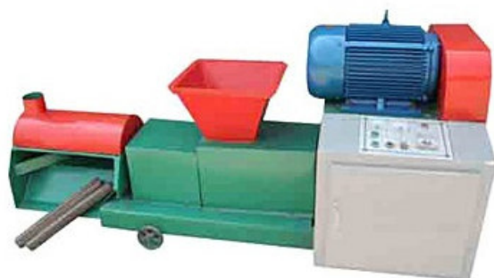
Fig 33 Greenforze Briquette Press – EkoBrik 150
